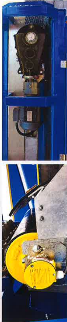
Le moteur électrique de la Terra Select E
